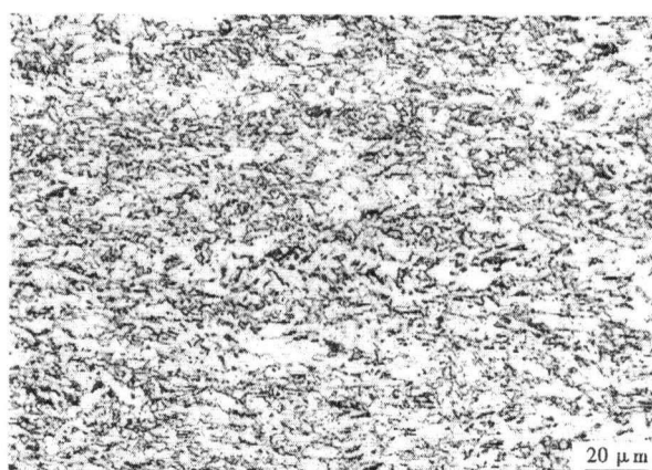
图4 针状铁素体型(AF型)X80级管线钢的组织形貌: B(B 粒 为主) + PF + P, 11.6 级
