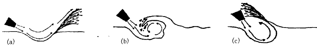
图 4 喷溅模型的示意图: (a) 向前喷溅; (b) 小喷溅; (c) 向后喷溅
