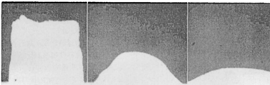
图 1 2 种保护渣熔化过程 Fig. 1 Melting process of two mold fluxes
