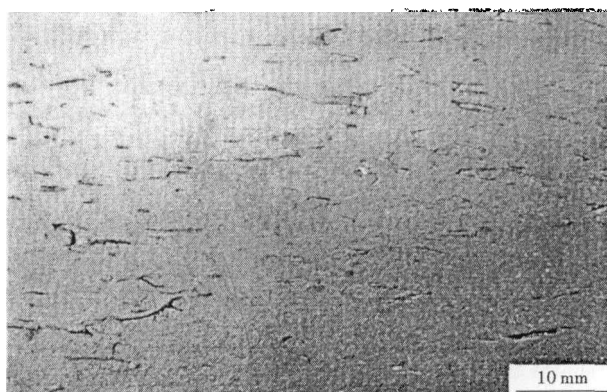
图 1 C-Mn 钢热轧板表面微裂纹形貌
