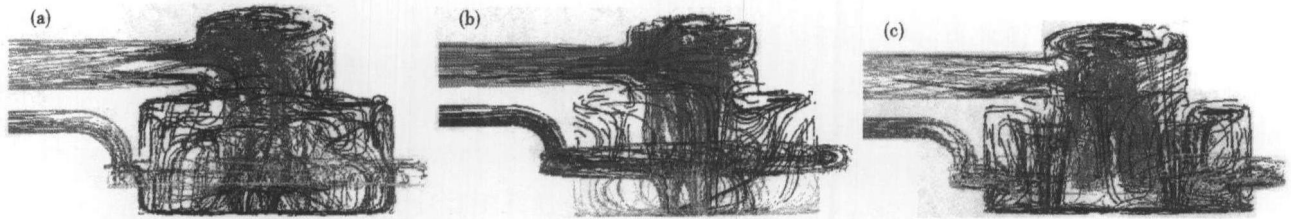
图 2 气流轨迹, 抽气压力 -150 Pa, 氩气入口流量 300 L/min, 净空高度和吹气孔位置: (a) 400 mm, 0.3 R; (b) 720 mm, 0.3 R; (c) 400 mm, 0.68 R
