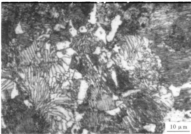
图 1 C70S6 钢的典型微观组织形貌,7-2-F: < 0.005\% \text{ Ti} , 锻造
