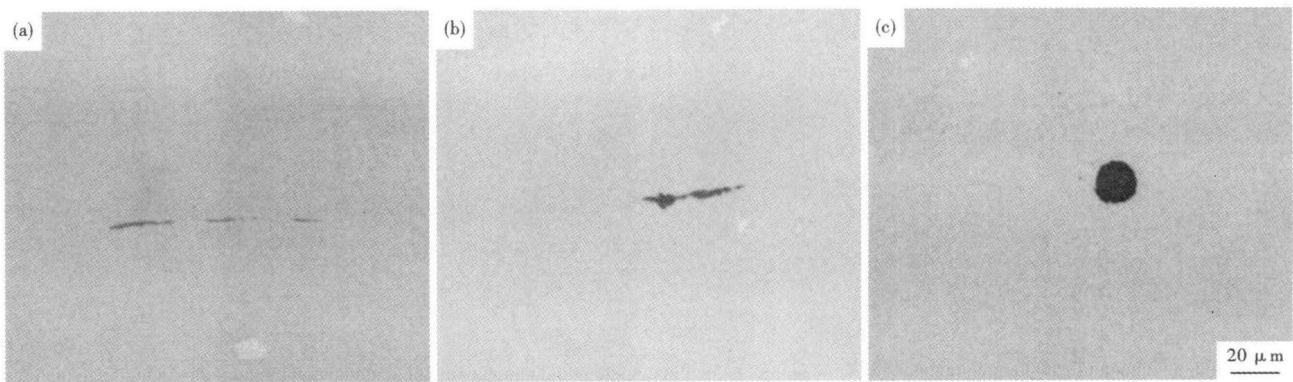
图1 12Cr1MoVG 钢圆管坯的非金属夹杂物形貌:(a)A类;(b)B类;(c)Ds类
