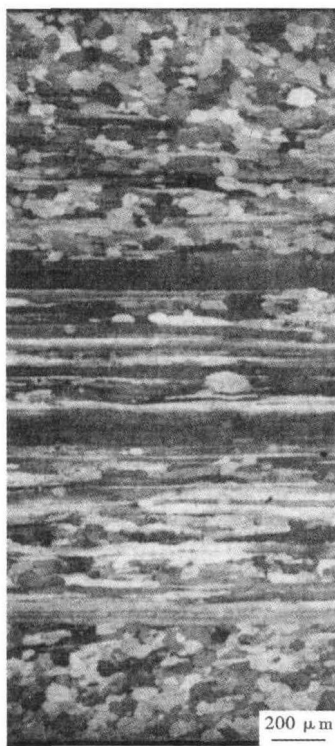
图 2 高牌号无取向硅钢 2.9 mm 热轧板组织形貌
