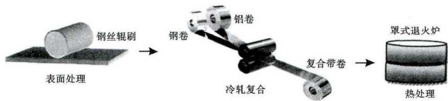
图 2 冷轧嵌入式铝-钢复合带材的工艺示意图
