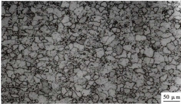
图4 0Cr13C 钢 Φ5.5 mm 坯料 740 °C 3 ~ 4 h 退火后的组织形貌
