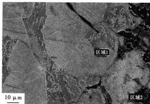
图 3 镜面塑料模具钢 P80R 150 mm × 615 mm 扁材表面裂纹附近组织和元素分析, SEM
