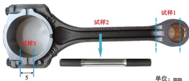
图2 36MnVS4钢连杆取样示意图
