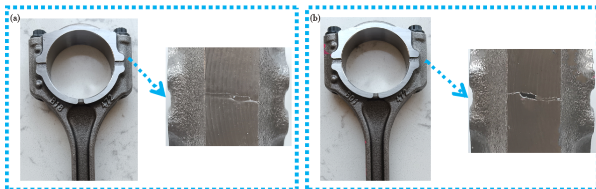
图1 36MnVS4连杆胀断缺陷宏观形貌：(a)1#试样，(b)2#试样
