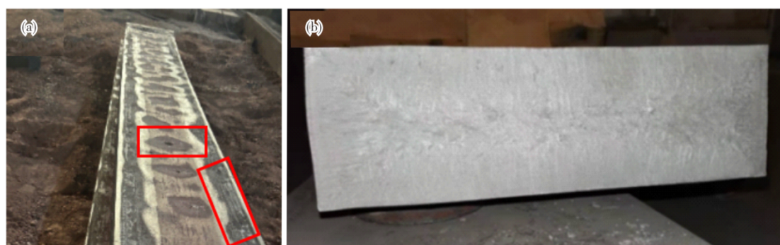
图1 Cr12MoV 连铸坯表面裂纹与断裂的宏观形貌:(a)表面裂纹, (b)断裂的宏观形貌
