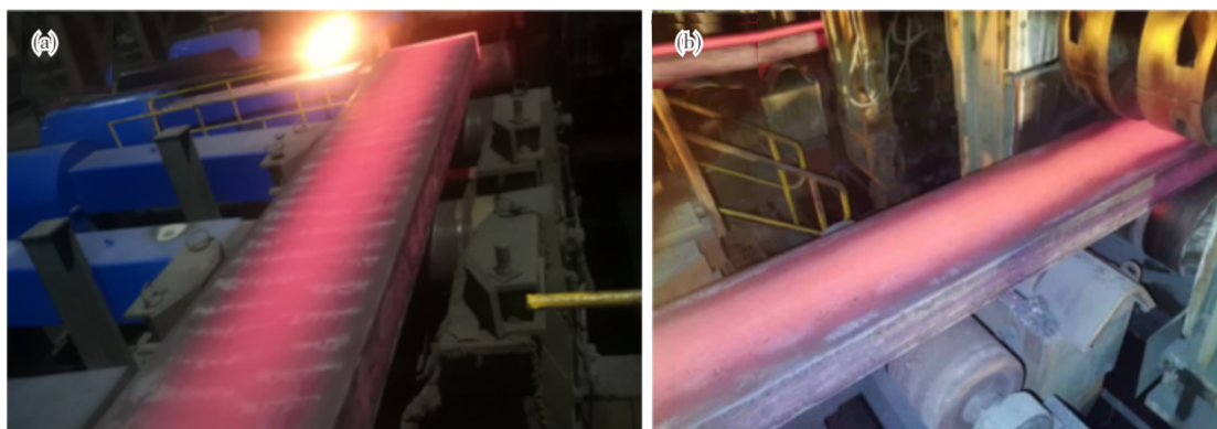
图 3 保护渣优化前后铸坯表面质量对比:(a)保护渣优化前铸坯表面质量,(b)保护渣优化后铸坯表面质量
