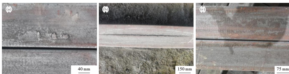
图3 M35 高速钢 150 mm×150 mm 方坯保护渣优化前后铸坯表面对比:(a)(b) 保护渣优化前 1#渣铸坯表面, (c) 保护渣优化后 2#渣铸坯表面
